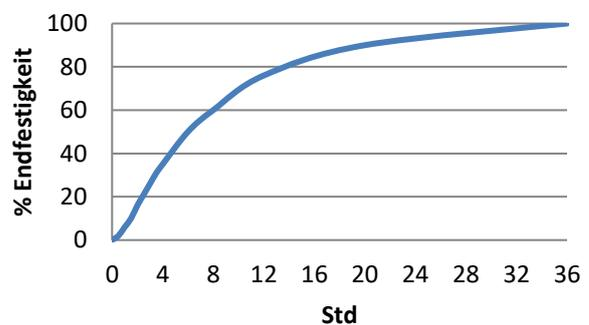
Das Diagramm zeigt den typischen Aufbau der Festigkeit bei der Verklebung von Probestücken bei 23°C. Aushärtung bei höheren oder niedrigeren Temperaturen beeinflusst die Aushärtungsgeschwindigkeit.
