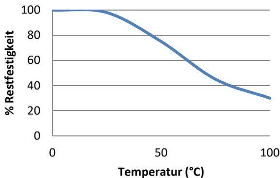
Vollständig ausgehärtete Testteile wurden vor den „Hitzebeständigen“ Scherfestigkeitsversuchen über 30 Minuten auf der Testtemperatur gehalten. TA4631 kann bei geringen Belastungen kurzzeitig auch höheren Temperaturen ausgesetzt werden (z.B. bei Einbrennlack- oder Schwall-Löt-Verfahren). Niedrigste Temperatur bei Endfestigkeit: -55°C (abhängig von den verwendeten Materialien).
