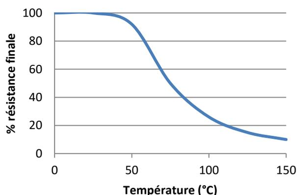
Tests de résistance au cisaillement à des températures élevées sur acier doux. Polymérisation complète à température ambiante, puis mise en température durant 30 minutes avant réalisation des essais.
