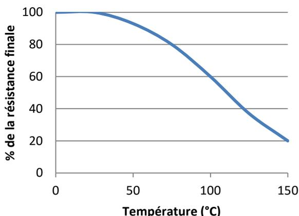
sur acier doux. Polymérisation complète à température ambiante, puis mise en température durant 30 minutes avant réalisation des essais.
