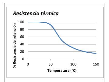
Resistencia térmica pruebas de resistencia realizadas en acero. Curado de 24 hr a temperatura ambiental y condicionado a la temperatura de prueba durante 30 minutos.
