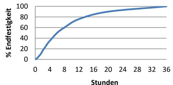
Das Diagramm zeigt den typischen Aufbau der Festigkeit bei der Verklebung von Probestücken bei 23°C. Aushärtung bei höheren oder niedrigeren Temperaturen beeinflusst die Aushärtungsgeschwindigkeit.
