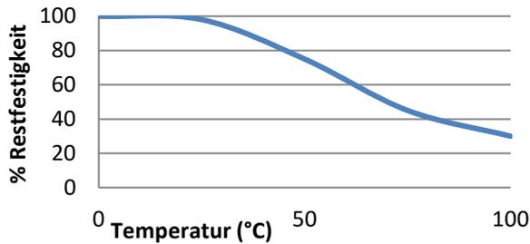
Vollständig ausgehärtete Testteile wurden vor den „Hitzebeständigen“ Scherfestigkeitsversuchen über 30 Minuten auf der Testtemperatur gehalten. TA4611 kann bei geringen Belastungen kurzzeitig auch höheren Temperaturen ausgesetzt werden (z.B. bei Einbrennlack- oder Schwall-Löt-Verfahren). Niedrigste Temperatur bei Endfestigkeit: -55°C (abhängig von den verwendeten Materialien).
