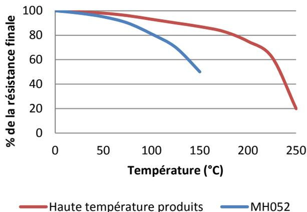
*"Dureté à chaud" l'évolution du couple de rupture en fonction du temps sur des boulons M10 en acier zingué selon la norme ISO 10964. Polymérisation de 24 heures à 23°C. Puis conditionnement de 30 minutes à des températures montrées dans le graphique.*
