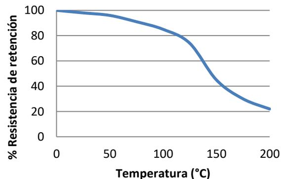
“Resistencia térmica” Pruebas de resistencia realizadas en acero. Ejemplares completamente curados y condicionados a la temperatura de prueba durante 30 minutos antes de la prueba.
