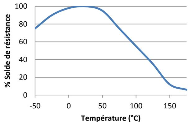
731 peut résister à des températures plus élevées (thermolaquage, soudure à la vague) pendant de courtes périodes, du moment que le joint n'est pas soumis à de trop fortes contraintes mécaniques. Température minimale après polymérisation: -55°C (-65°F) selon les matériaux.
