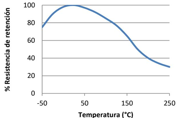
Las pruebas de resistencia al corte bajo el modo de "resistencia en caliente" se llevaron a cabo en acero dulce. Inicialmente, se fijaron a temperatura ambiente con un curado posterior a 150°C durante dos horas. Las partes a probar se acondicionaron a la temperatura de prueba desde 30 minutos antes de la prueba.
